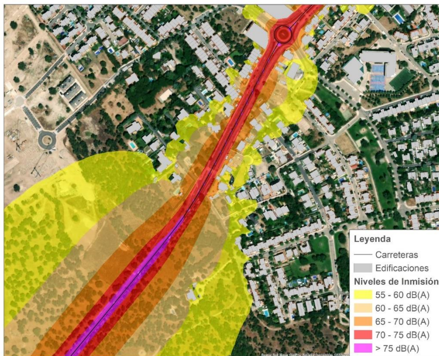
Ilustración 27: Discontinuidad de isófonas por cambio de velocidad.
