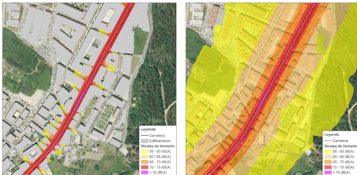
Ilustración 2: Diferencia entre un mismo modelo calculado con obstáculos (imagen de la izquierda) y sin ellos (imagen de la derecha).
