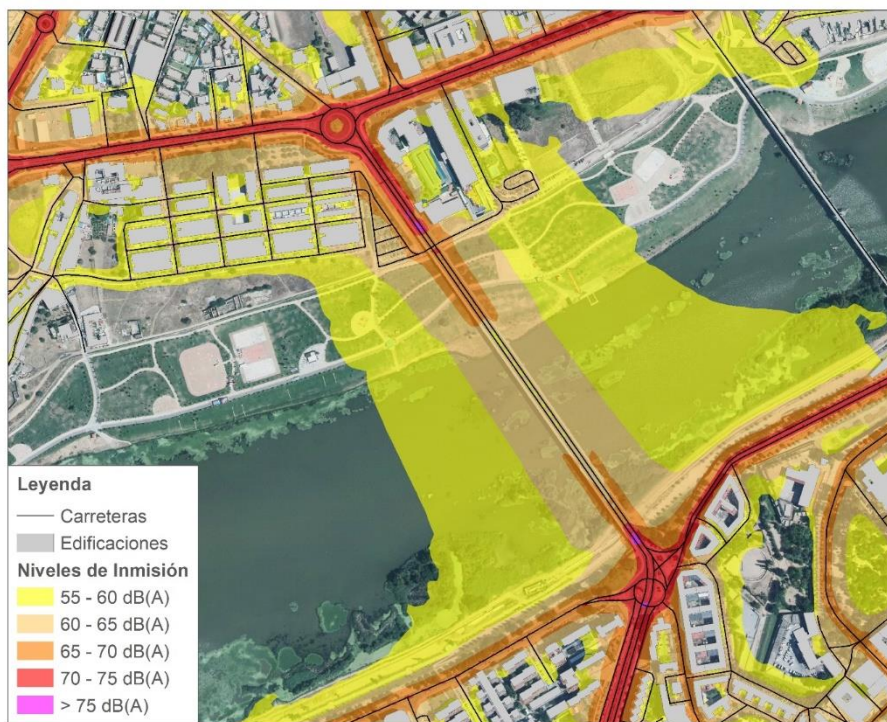
Ilustración 26: Discontinuidad de isófonas por presencia de paso elevado.
