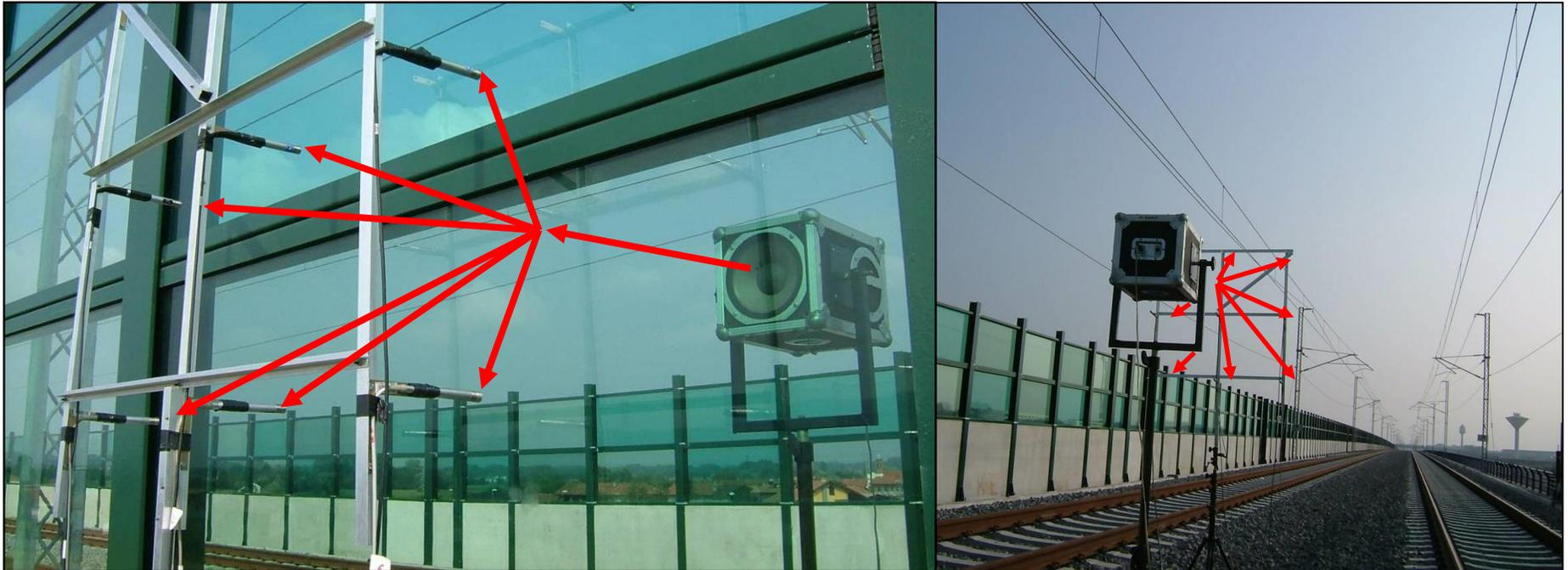
Adquisición de respuestas de impulso mediante un emparrillado de 9 microfones bajo campo sonoro directo: **Frente a la muestra,** y **en campo libre**
