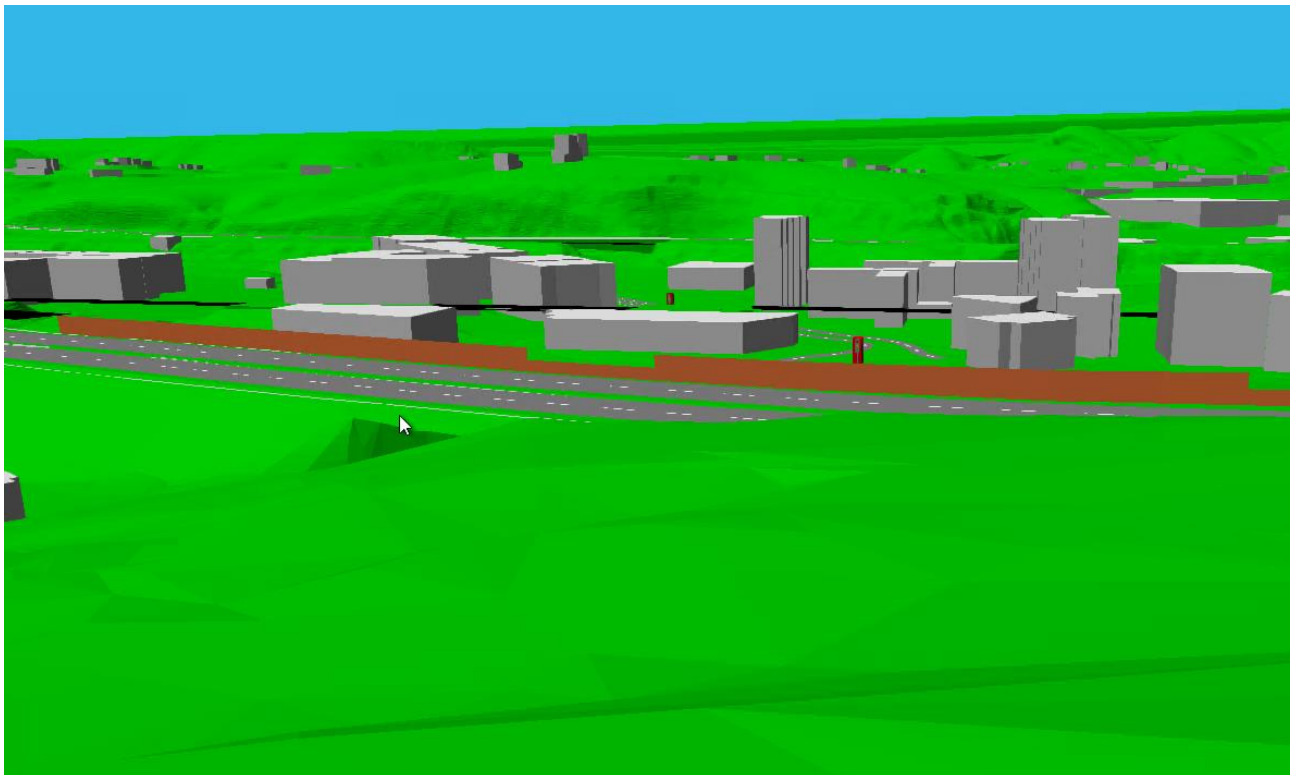
Figura 4. Modelo 3D de la pantalla prevista en la AP-8 en Errenteria.
