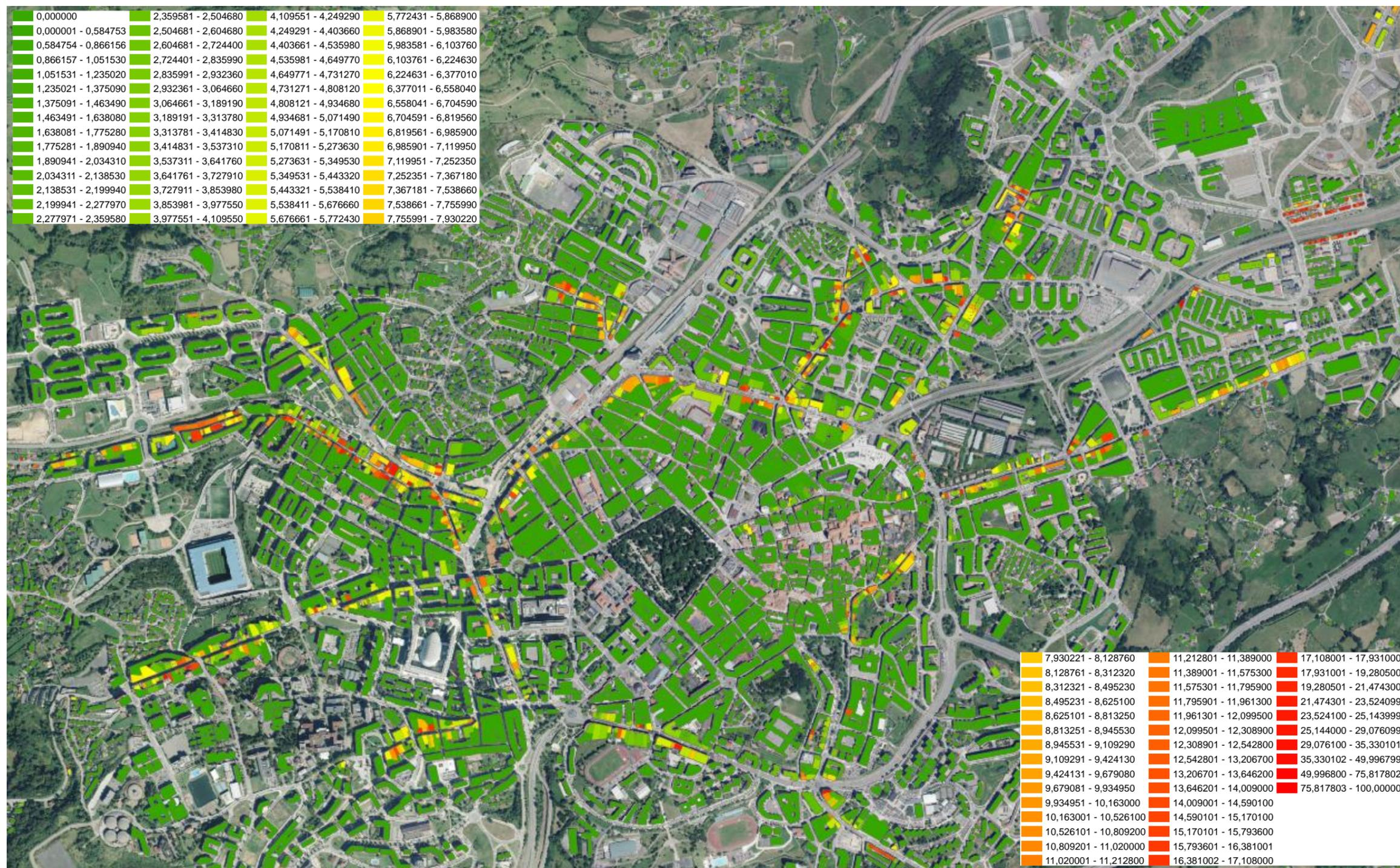
Figura 11. – Índice de afección específico por edificio para ruido de tráfico rodado.
