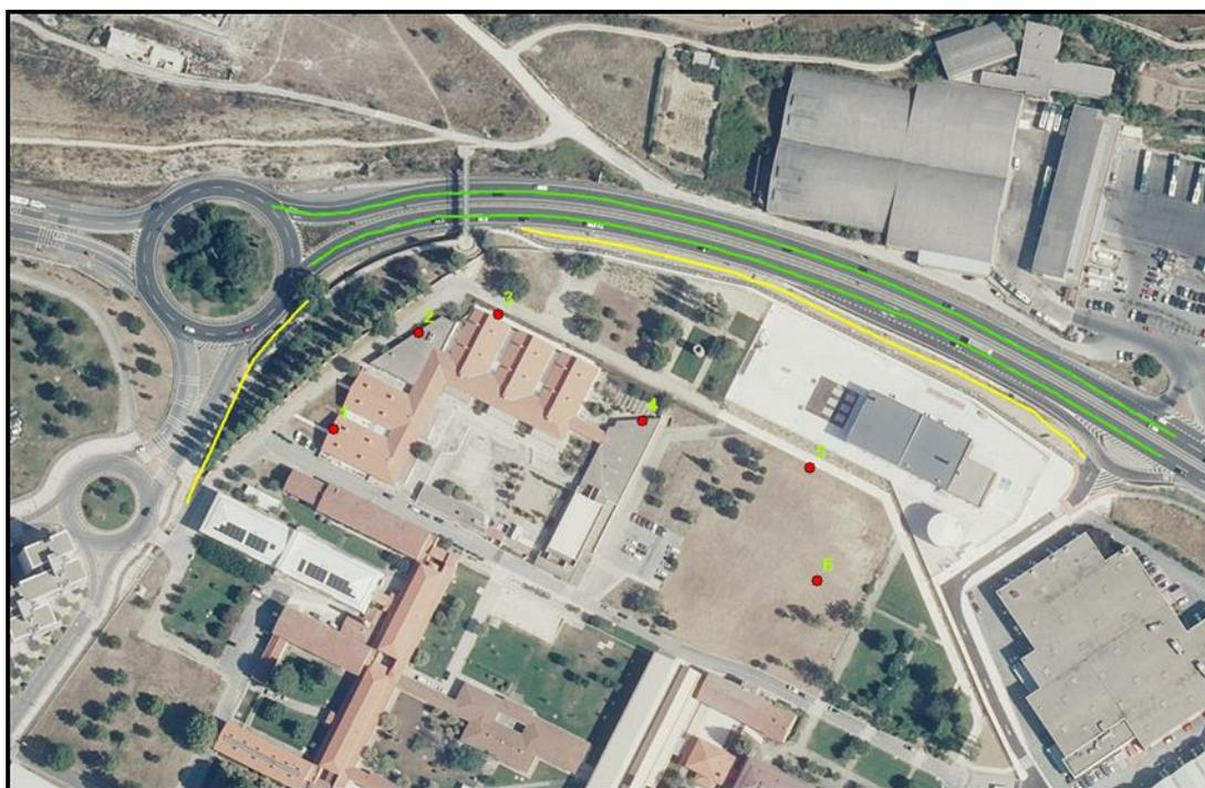
*Ilustración 33. Pantallas acústicas proyectadas y asfalto fonoabsorbente en el Plan Zonal 3 - Valle del Roncal*
