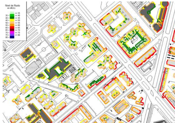
Detalle de los niveles de ruido en fachada en el Área 3
