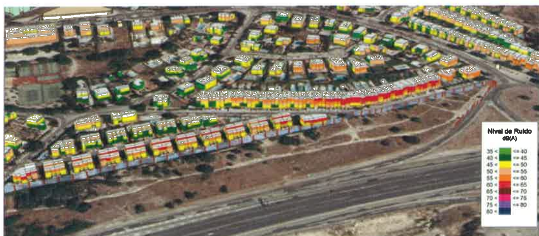
Niveles en fachadas. Situación con pantalla acústica
