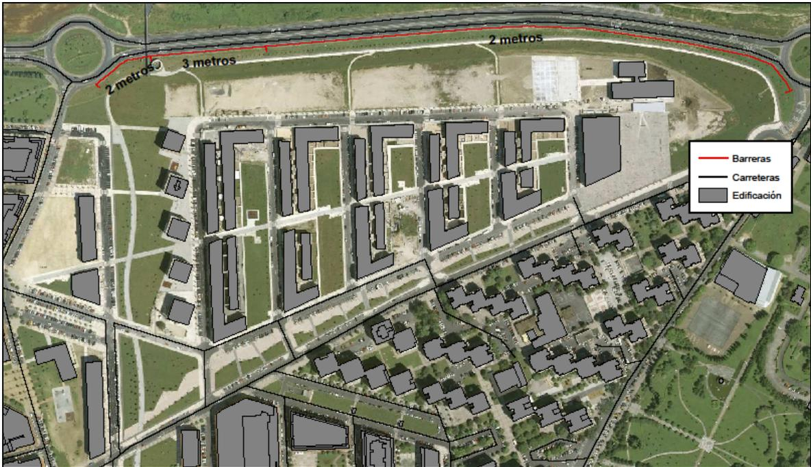
Fig. 54- Distribución y altura de las barreras diseñadas.
