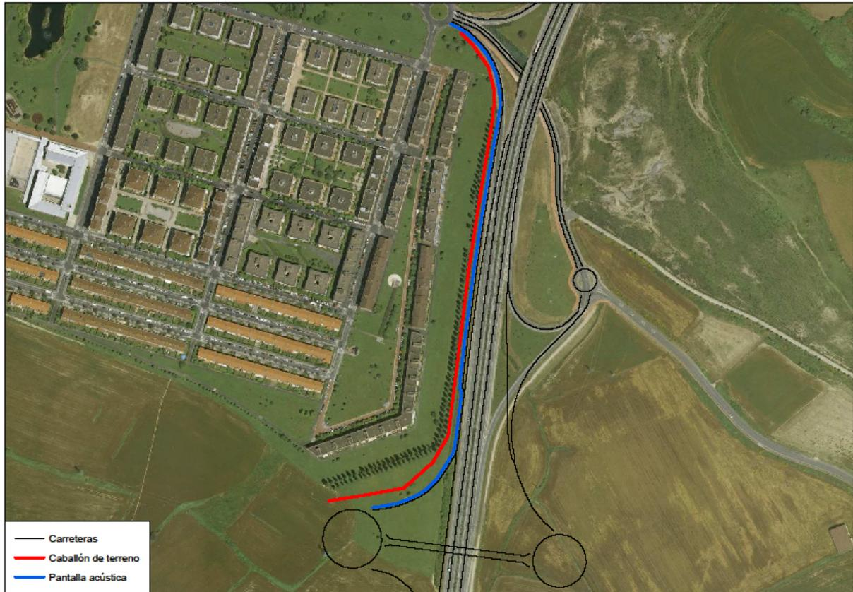
Fig. 62 – Proyección del caballón de terreno y pantalla acústica artificial (zona sur).
