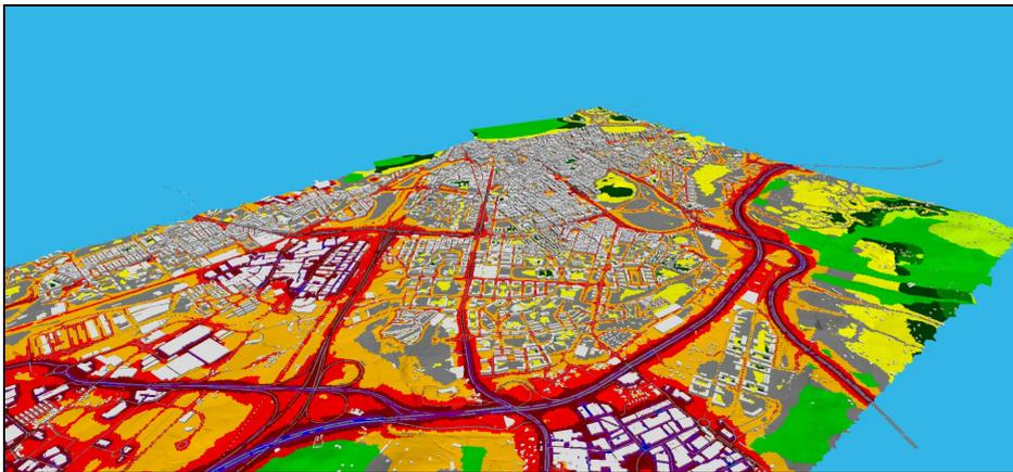
Imagen 7. Ejemplo de Malla de Ruido sobre modelo tridimensional.
