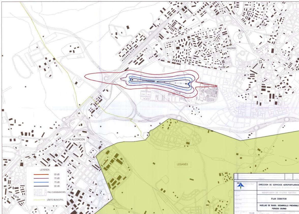
Ilustración 8. Huella acústica del aeropuerto de Cuatro Vientos.
