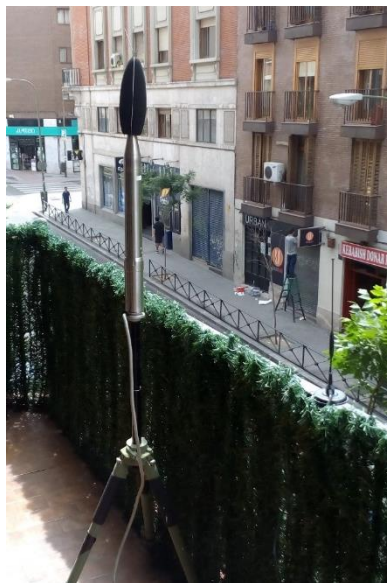
Ilustración 10. Estación de Monitorizado de Ruido Móvil
