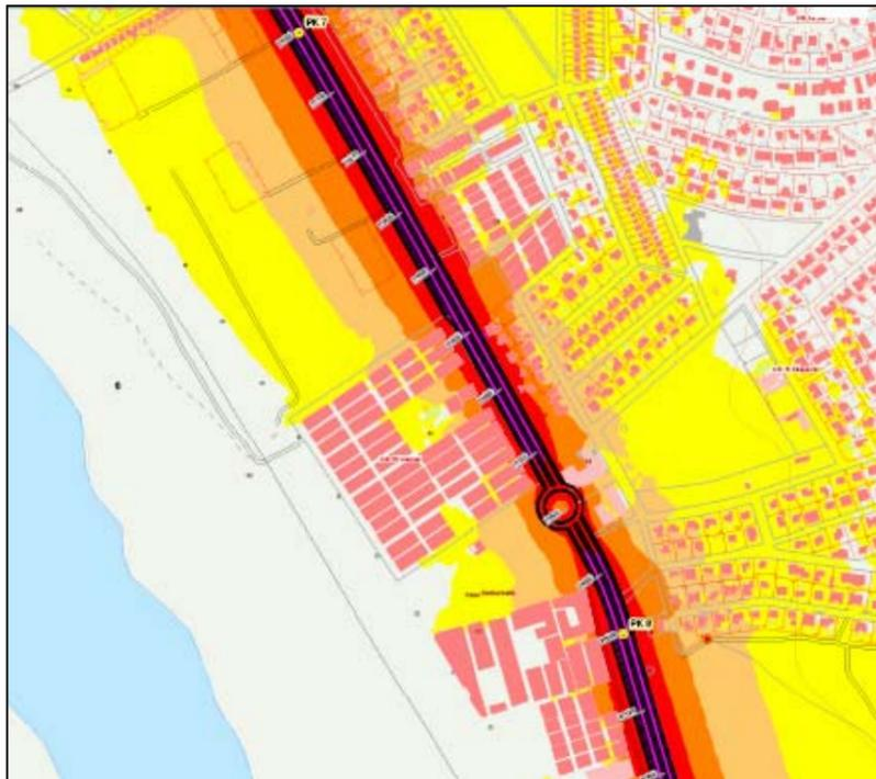
Ilustración 56. Tramo 6 de estudio de la carretera CV-905, con los niveles de ruido Lden dB(A) reflejado según la leyenda de colores.
