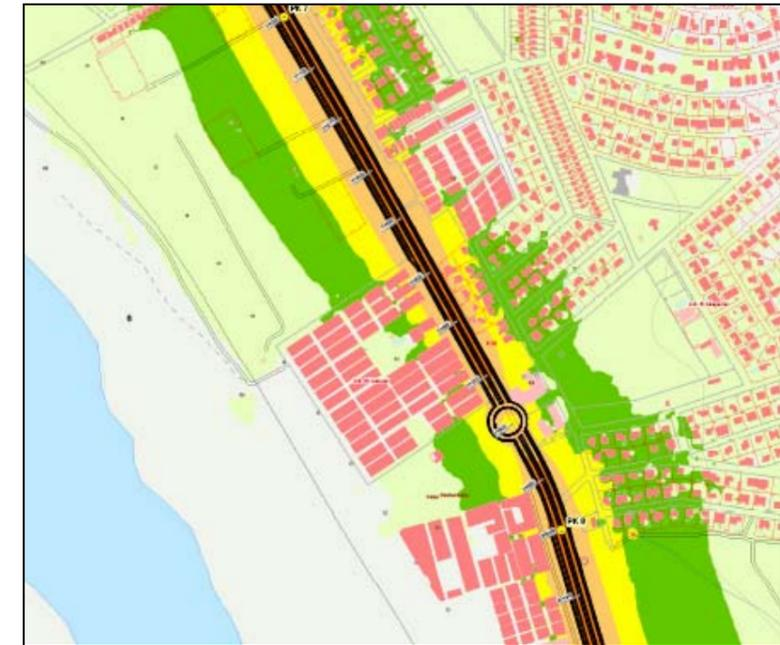
Ilustración 57. Tramo 6 de estudio de la carretera CV-905, con los niveles de ruido Lnoche dB(A) reflejado según la leyenda de colores.
