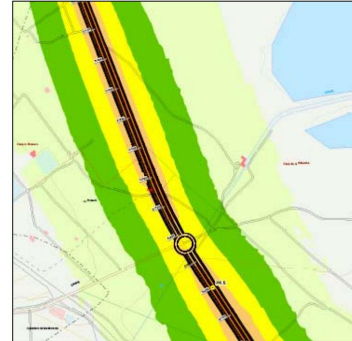
Ilustración 52. Tramo 4 de estudio de la carretera CV-905, con los niveles de ruido Lnoche dB(A) reflejado según la leyenda de colores.
