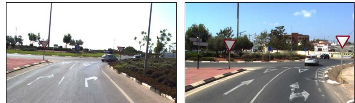
En relación a la sección transversal de la carretera es preciso diferenciar dos tramos: entre el P.K. 0+000 y el P.K. 1+200 la carretera cuenta con dos carriles por sentido de 3,5 metros, arcenes exteriores de 1,8 metros e interiores de 0,5 m. La separación de ambos sentidos de circulación se materializa mediante un bordillo. En el tramo comprendido entre el P.K. 1+200 y P.K.2+500 la carretera cuenta con un carril por sentido de 3,5 m y arcenes de 1,6 metros en todos los casos.
